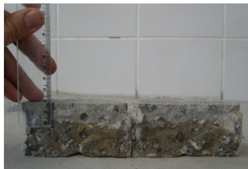
Figura 4. Fatia de corpos de prova após ruptura e aplicação de solução aquosa de 0,1 \text{ M} de \text{AgNO}_3 .
