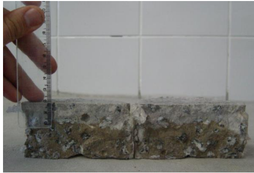
Figura 4. Rebanada de probeta posterior a la ruptura y aplicación de solución acuosa de 0,1 M de \text{AgNO}_3 .
