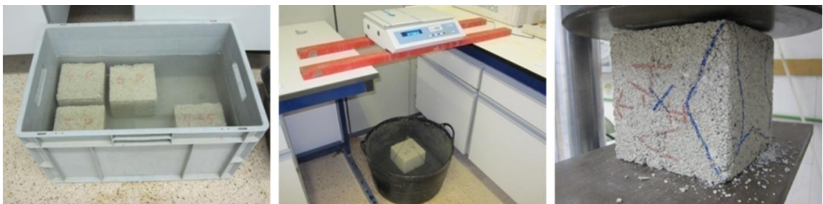
Figura 3. Procedimiento para ensayo de las probetas de hormigón (de izquierda a derecha): Probetas sumergidas hasta saturación; obtención de la densidad y absorción; rotura en prensa.
