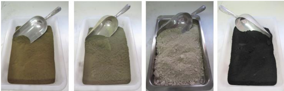
Figura 1. Adiciones minerales utilizadas en la investigación (de izquierda a derecha): Ceniza de lodo de depuradora (CLD); ceniza volante (CV); polvo de mármol (PM); ceniza de cáscara de arroz (CCA).
