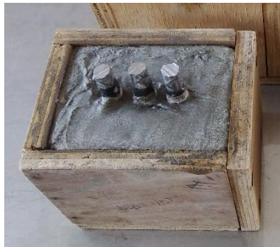
Figura 2. Bloque de concreto con tres barras de acero de refuerzo.
