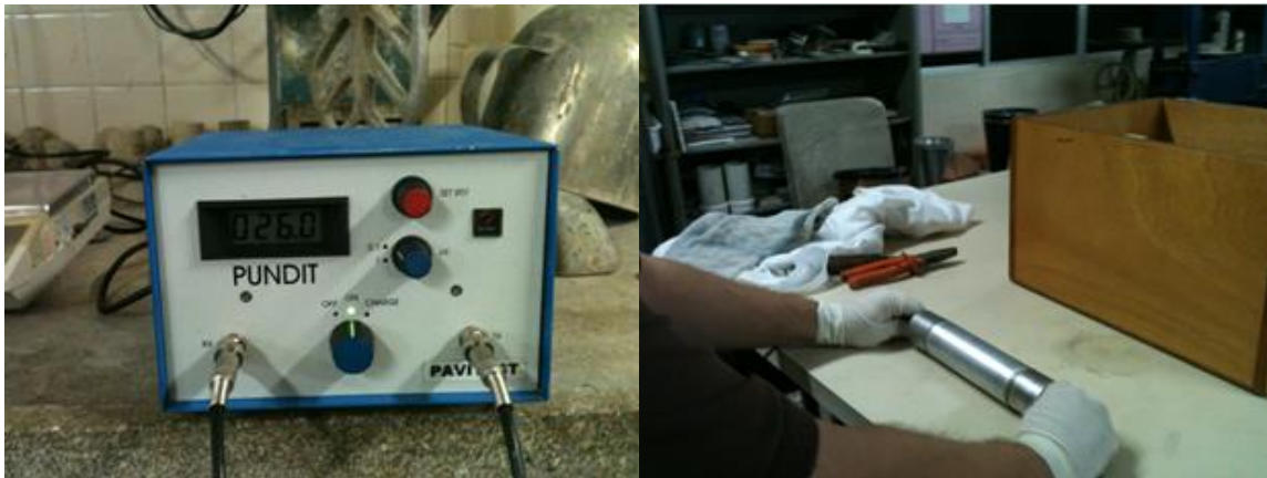
Figuras 3. (A) e (B). Equipamento e calibração PUNDIT (Portable Ultrasonic Non-destructive Digital Indicating tester)
