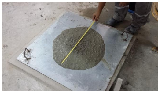
Figura 5. Medida do espalhamento do concreto auto adensável
