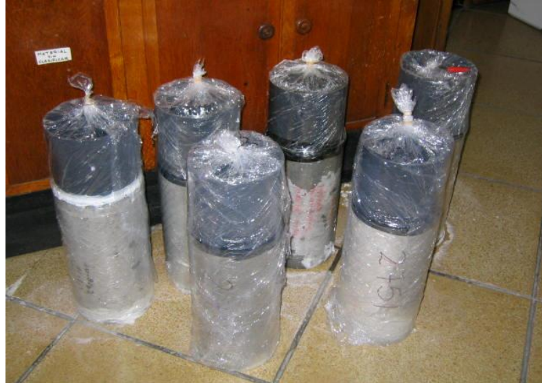
Figura 3. Ensayo natural de difusión de cloruros.
