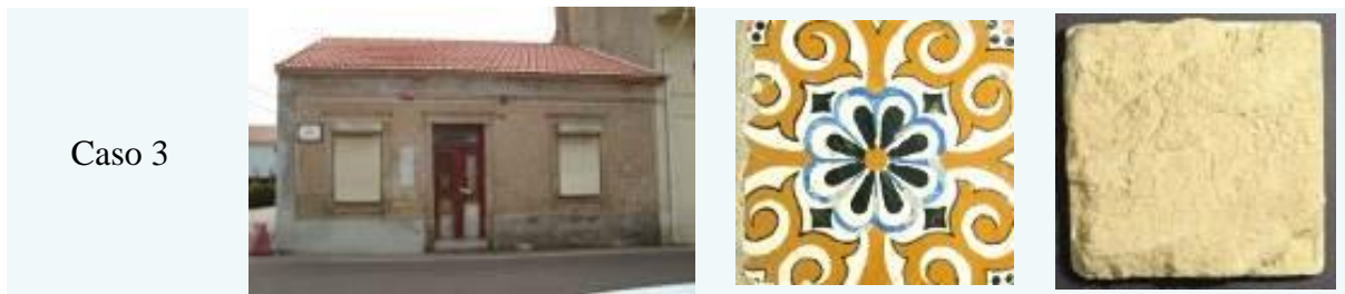
Figura 2. Fachada, detalhe do azulejo e amostras de argamassas de assentamento aderidas no tardo das placas dos três casos analisados.
