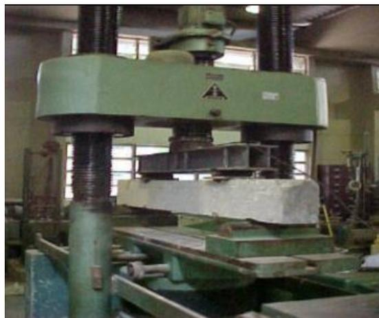
Figura 6. Prensa utilizada para los ensayos de flexión de vigas
